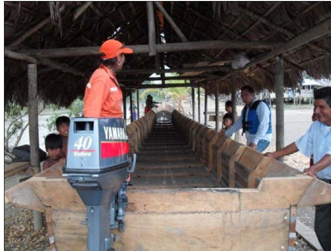
Foto 126. Proyecto terminación de un bote en madera de 16m de eslora y compra de un motor Yamaha 40HP
