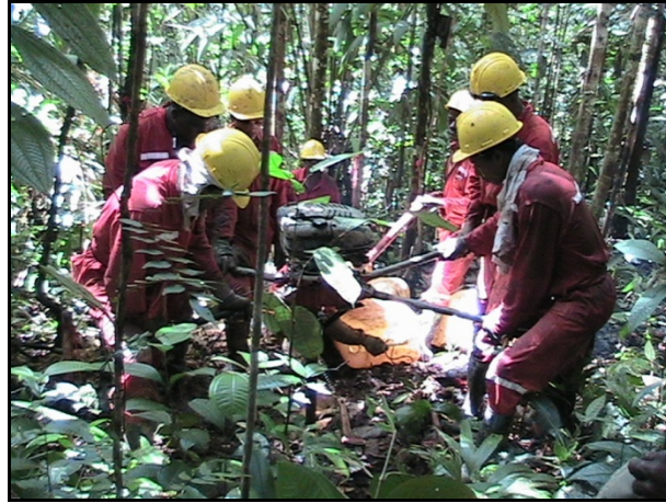
Foto 17. Perforación con taladro portátil y sistema de aire
