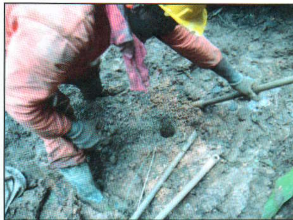
Foto 16. Cargado de Pozo
