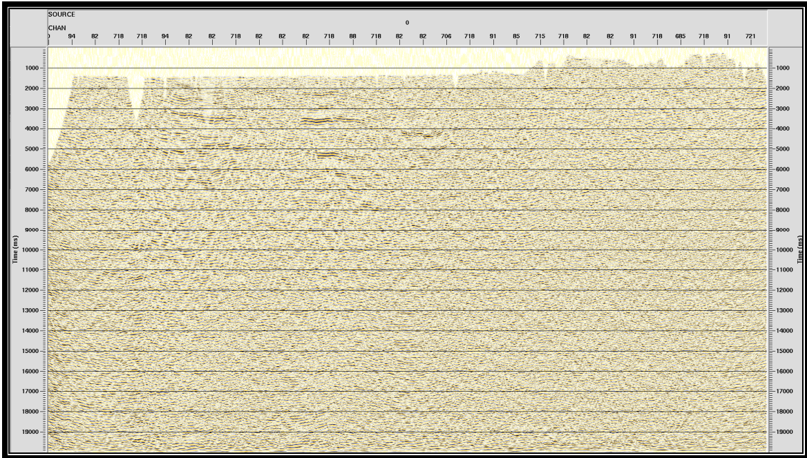
Figura 11. PSTM a 20s de la línea ANH-TR-06-04A. Sección Bolívar - Santander
