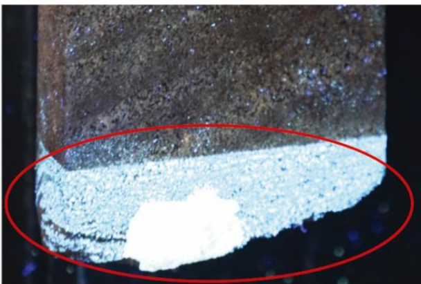
Fotografía en luz ultravioleta contaminada con pegamento de cinta de enmascarar utilizada para marcar la profundidad.
