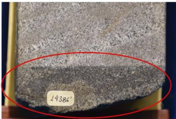
Fotografía en luz natural contaminada con pegamento de cinta de enmascarar utilizada para marcar la profundidad.
