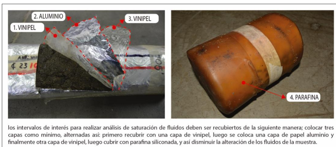
Figura 9. Preservación con vinipel, aluminio y parafina.
