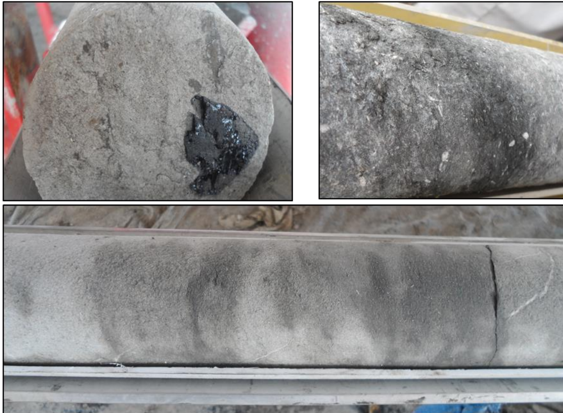
Caliza Eocena Con Aceite e impregnada de Asfalto Pozo ANH Tierralta St
