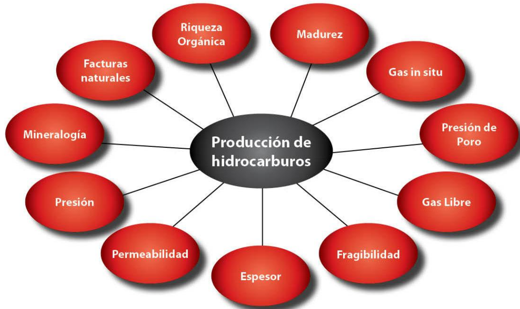
Figura 10. Parámetros físicos que definen la viabilidad económica de una acumulación de hidrocarburos asociada a lutitas (adaptado de Halliburton, 2010).
