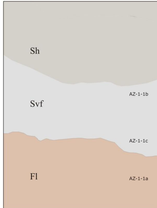
Figura 3.19 El nivel Svf corresponde a un horizonte de caída de cenizas volcánicas masivo, tamaño de arena grueso (lapilli). El nivel infrayacente F1 corresponde a lodolitas verdes con abundantes restos de plantas, allí se tomó la muestra AZ-1-1a para análisis de polen. Fotografía tomada en la poligonal Flanco Oriental Anticlinal A (AZ-1) alrededor estación GPS 36.
