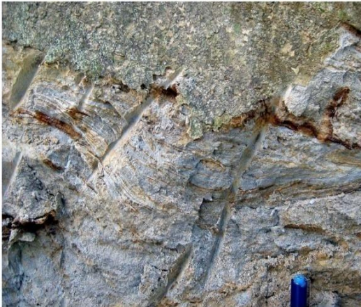
Figura 3.22 Arriba, tramo de poligonal Occidente Anticlinal A (AZ-5), Segmento IV de la columna estratigráfica (ver Anexo 13.2). En este tramo se tomó la muestra AZ-5-2 correspondiente a una arena tobácea. Abajo detalle de nivel con estructuras de slump .
