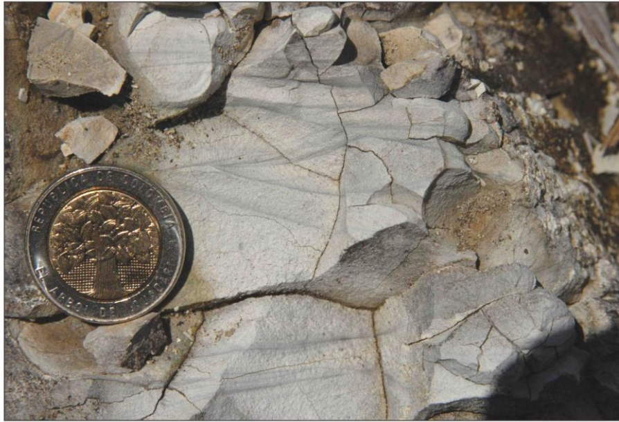
Figura 3.14 Arenitas tobáceas con laminación inclinada. Muestra Stb-2 ANH-7 para análisis petrográfico tomada del Segmento II de la Columna Potrero Artesa (Anexo 11.3).
