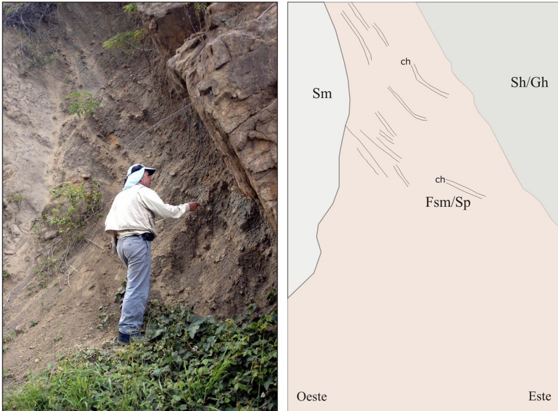
Figura 3.26 Horizonte con pedogénesis conformado por intercalaciones de lodolitas arenosas con estratificación inclinada (Facies Fsm/Sp) y niveles laminares de calcretas (ch). En este nivel se tomó la muestra AZ-10-2 para análisis de polen. Sh/Gh: arenitas de grano grueso intercaladas con conglomerados. Sm: facies de arenitas de grano medio sin estructura visible con nódulos de calcreta. Segmento I de la Columna Occidente Sinclinal B (Anexo 13.5).
