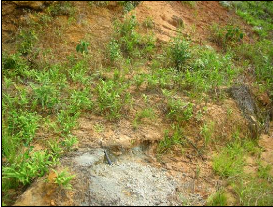
Figura 3-42. Arcillolita homogénea muy meteorizada, de color gris verdoso con tonos naranja amarillento por oxidación.
