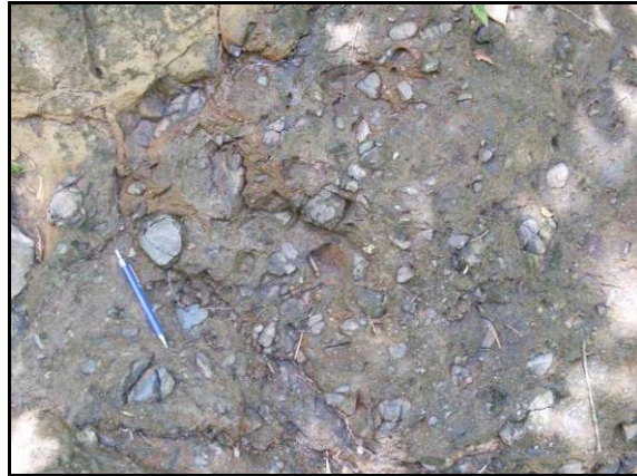
Figura 3-95. Conglomerado polimítico matriz soportado de trama desordenada con guijos subangulares a bien redondeados de rocas ígneas de la unidad infrayacente (Grupo Diabásico).
