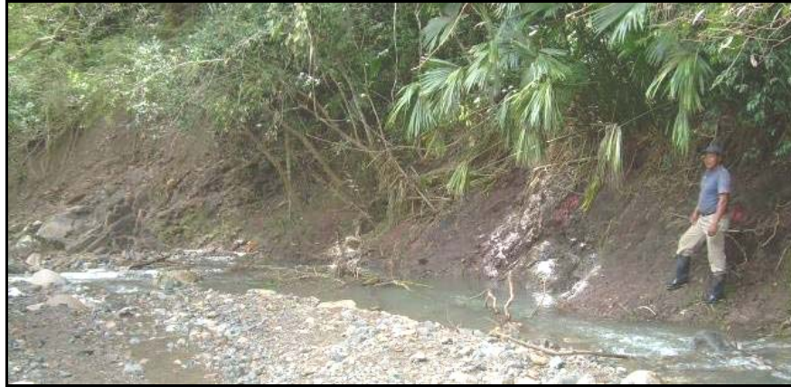
Figura 3-78. Capas muy gruesas tabulares de lodolita, rojiza muy alterada, sin estructura interna apreciable y abundantes óxidos de hierro
