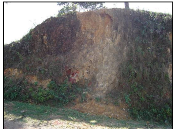
Figura 3-23. Capas medias y gruesas de arenitas feldespáticas con estratificación ondulosa no paralela y óxidos de hierro.
