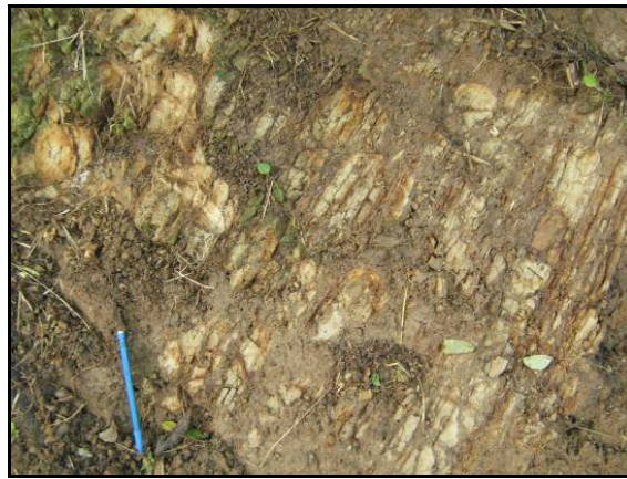
Figura 3-7. Sarenitas líticas friables con laminación plano paralela continua, en capas medias y delgadas de geometrías tabulares.
