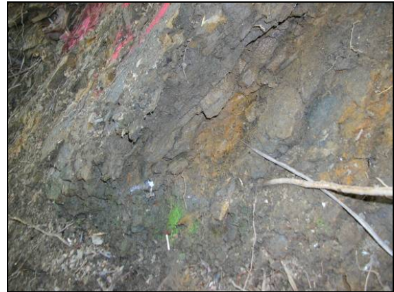
Figura 3-17. Intercalaciones de lodolitas color gris medio con laminación plana paralela y arenitas homogéneas.
