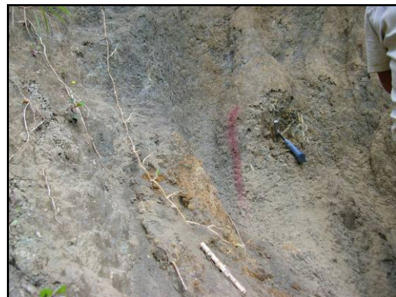
Figura 3-19. Arcillolitas, moteadas, levemente calcáreas de colores pardo rojizo, gris y ocre, localmente con laminación ondulada discontinua.
