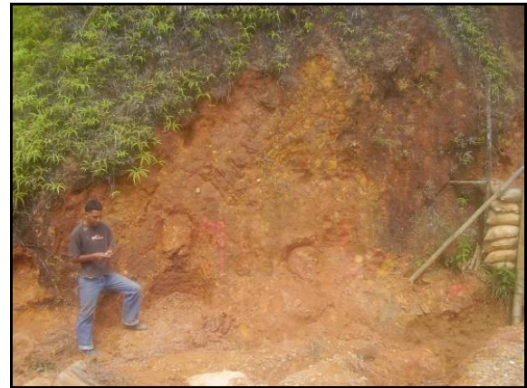
Figura 3-26. Conglomerado polimítico clasto y matriz soportado homogéneos de guijos y guijarros subredondeados de rocas volcánicas e ígneas intrusivas.
