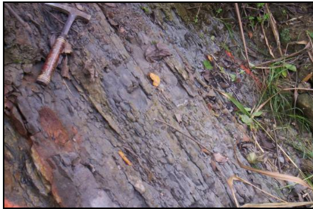
Figura 3-64. Capas delgadas de limolita arenosa a arenita limosa con estratificación plano paralela continua, tabulares.
