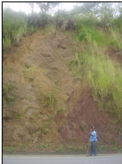
Figura 3-3. Banco de limolita roja, suprayacido por paquetes métricos de arenita con gradación normal.
