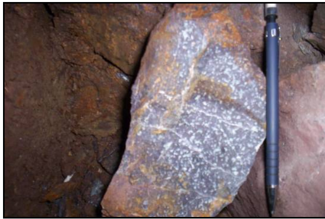
Figura 3-60. Basalto amigdalares pseudoestratificado algo alterado.
