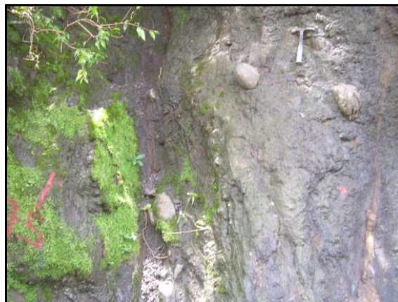
Figura 3-55. Lodolita a arcillolita homogénea ligeramente calcáreas, con concreciones calcáreas.
