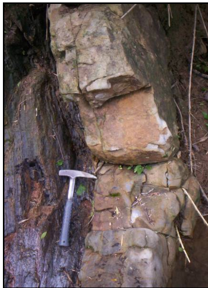
Figura 3-66. Arcillolita carbonosa con laminación plano paralela y ondulada, continua, intercalada con cuarzoarenitas homogéneas de grano muy fino, compactas de color gris medio, con geometría subtabular.
