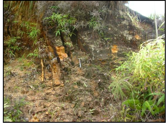
Figura 3-43. Arenitas con laminación inclinada de color amarillo, en capas medias canaliformes, contacto irregular.
