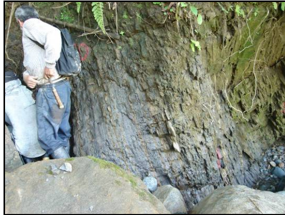
Figura 3-68. Interposición de capas de lodolita y de arenitas con alto contenido de materia carbonosa y estructuras lenticulares y flaser.
