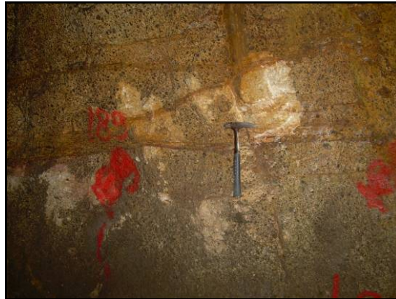
Figura 3-46. Conglomerado polimítico clasto soportado de trama desordenada, color gris claro, con guijos y guijarros redondeados de cuarzo lechoso y chert.
