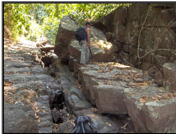
Figura 9. Tobas en capas gruesas subtabulares con fracturas abiertas perpendiculares a la estratificación. (Estación: RR023. Foto No.: 1021. Az: 130°. Formación: La Quinta).
