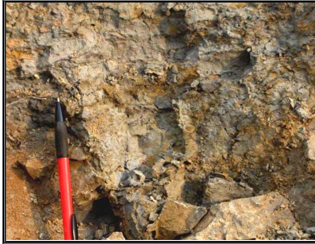
Figura 51. Arcillolitas macizas grises claras sin estructura interna aparente. Se presenta con moteados amarillos ocres debido a óxidos de hierro y fantasmas de raíces (Columna 11, metro 41, foto 1362, RR. Az: Detalle. Formación Los Cuervos).
