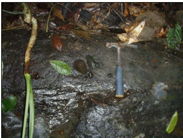
FOTOGRAFÍA: 29 y 30 FOTO DIGITAL: AC053+000 A – QM003+050 A ACIMUT: Detalle DESCRIPCIÓN: Arenita conglomerática en la sección Agua Clara; Arenita conglomerática en la sección Quebrada Malambo. Facies ACg: Arenita conglomeráticas macizas de grano grueso homogéneo granodecrecientes.
