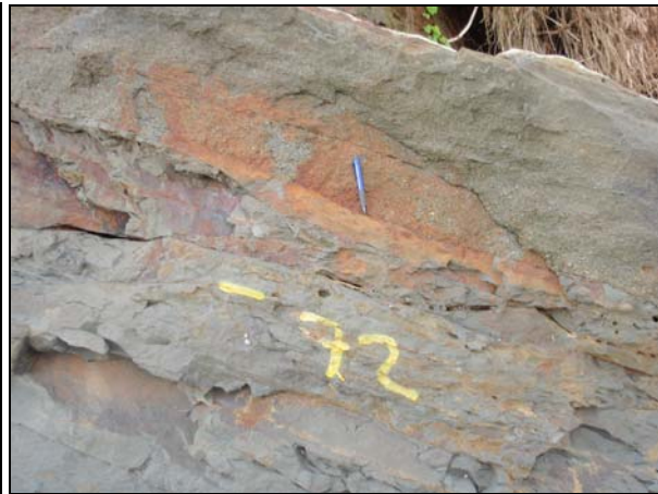
FOTOGRAFÍA: 45 y 46 FOTO DIGITAL: L072+100 A - L072+000 B ACIMUT: Detalle DESCRIPCIÓN: Capa de conglomerado con predominio de intraclastos lodosos Sección Ladrilleros. Sucesiones de asociación de facies 5 de depósitos de flujos de escombros.
