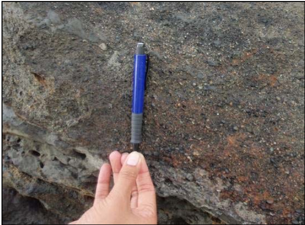
FOTOGRAFÍA: 45 y 46 FOTO DIGITAL: L072+100 A - L072+000 B ACIMUT: Detalle DESCRIPCIÓN: Capa de conglomerado con predominio de intraclastos lodosos Sección Ladrilleros. Sucesiones de asociación de facies 5 de depósitos de flujos de escombros.
