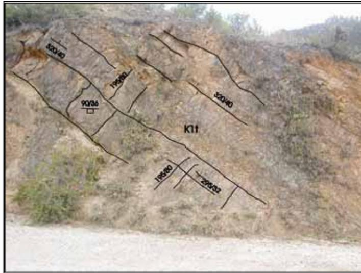
Figura 77. Estación: AB-020. Foto: AB-020. Tipo: Afloramiento. Carpeta AB. Azimut: 240°. Descripción: Arcillolitas y Arenitas de capas delgadas a medias de la parte basal de la Formación Tibasosa ( $K_{1t}$ ). Coordenadas:  $N= 1.144.431$ ,  $E= 1.137.759$ , origen Bogotá.
