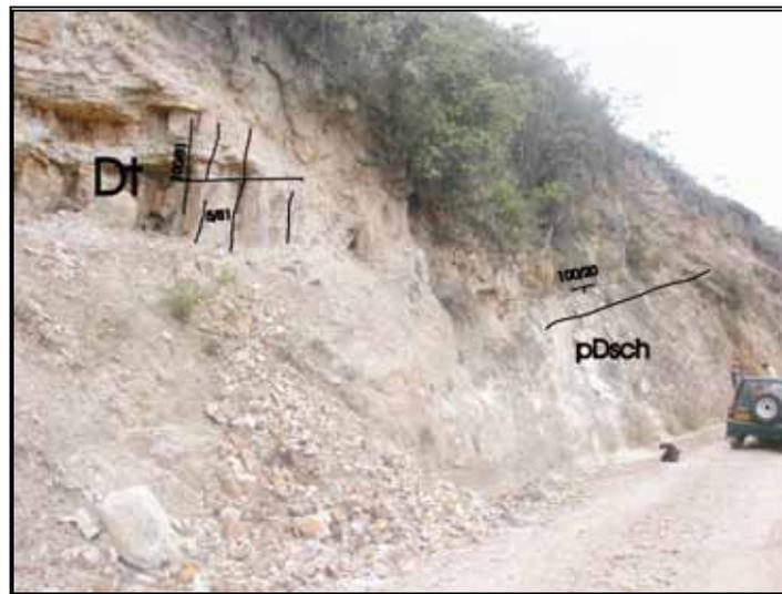
Figura 63. Estación: AB-005. Foto: AB-005. Tipo: Afloramiento. Carpeta AB. Azimut: 065°. Descripción: Contacto Formación Tibet (Dt) y la Granodiorita de Chuscales – Aguaclara. Coordenadas: N= 1.144.343, E= 1.131.125, origen Bogotá.
