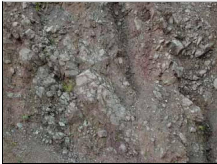
Figura 67. Estación: JM241. Foto: FJM241. Tipo: Afloramiento. Carpeta: JM. Acimut: 290°. Descripción: Zona de cizalla en arcosa y conglomerado polimíctico, de color gris rojizo. Unidad: Formación la Rusia (Jlr). Coordenadas: N= 1.146.135, E= 1.121.271, origen Bogotá.
