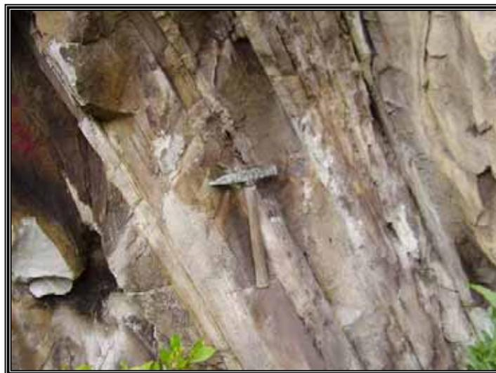
Figura 118. Foto: FC5-04. Metraje: 102.0. Azimut: 185°. Descripción: Capas canaliformes de arenita cuarzosa grano fino con impregnación de petróleo. Unidad: Formación Picacho. Coordenadas: N= 1140145, E= 1139090, origen Bogotá.
