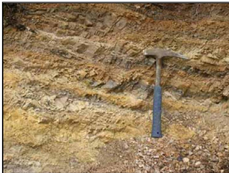
Figura 88. Estación: JM173. Foto: FJM173. Tipo: Detalle. Carpeta: JM. Acimut: 234°. Descripción: Fracturamiento en capas tabulares finas a muy finas de Limolitas silíceas color gris medio a crema. Unidad: Formación Plaeners (K<sub>2p</sub>). Coordenadas: X= 1126036.142-Y= 1155708.06. Origen Bogotá
