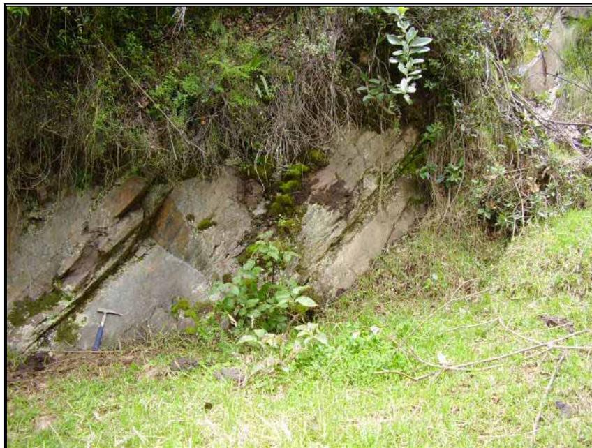
Figura 71. Estación: JR033. Foto: JR65. Tipo: Afloramiento. Carpeta: JR. Azimut: 165°. Descripción: Capas subtabulares gruesas de limolita verdosa. Unidad: Formación Girón. Coordenadas: N= 1.149.944, E= 1.139.672, origen Bogotá.
