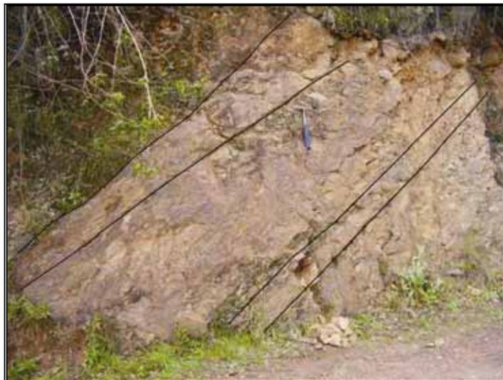
Figura 70. Estación: JR032. Foto: JR64. Tipo: Afloramiento. Carpeta: JR. Azimut: 220°. Descripción: Capas subtabulares gruesas de arenitas de grano fino y arenitas conglomeráticas de color rojo violáceo. Unidad: Formación Girón. Coordenadas: N= 1.149.804, E= 1.139.526, origen Bogotá.
