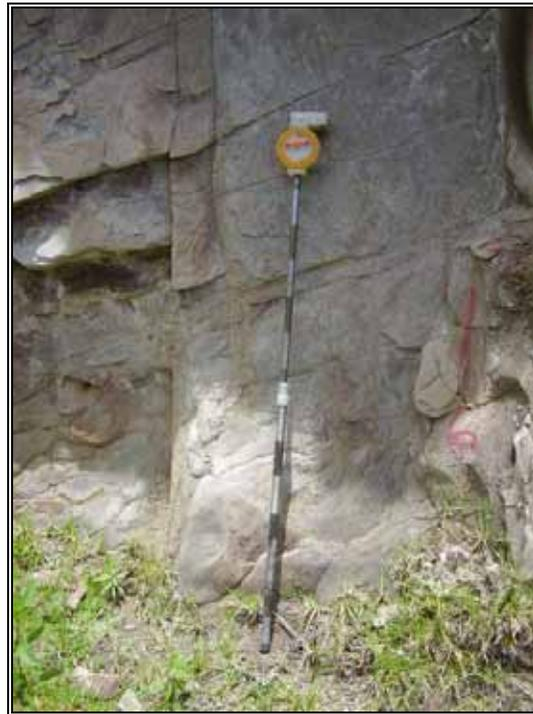
Figura 18. Bastón de Jacob, consta de: Nivelador, transportador, rayo láser y longitud de 1.5 metros con subdivisiones cada 10 centímetros.
