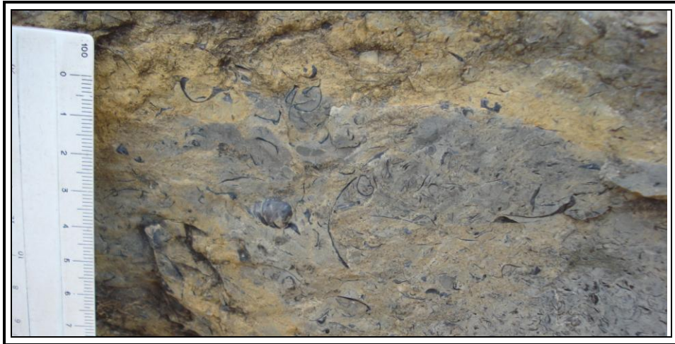
Foto C131. Estación C131 (transecta-3): Calizas (wackestone) de color gris, amarillo por alteración, con conchas de bivalvos, de la Formación Tibasosa (bloque colgante de la Falla de Soapaga).
