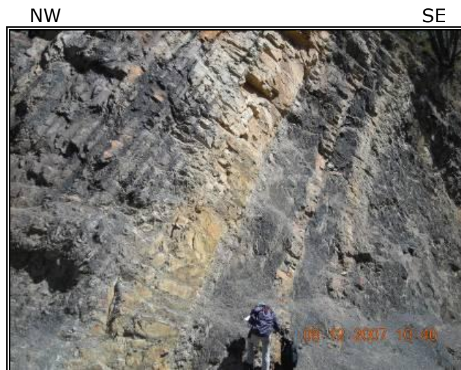
Foto UC2 (Sección Ubaté-Carupa). Shales limosos, silíceos, color gris oscuro a negro, con interposiciones desde muy gruesas hasta muy delgadas, de cuarzo arenitas de grano muy fino, y niveles muy delgados y medianos tabulares de limolitas silíceas, el color es gris claro. Formación Simijaca. Bloque yacente de la Falla de Carupa, al sur-sureste de Carmen de Carupa.
