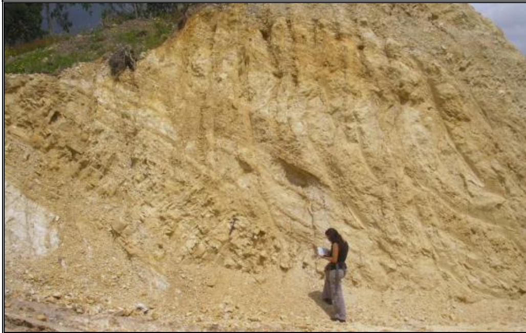
Foto M92. Estación M92: Lodolitas caolinizadas, color gris muy claro, cuarzoarenitas de grano muy fino, limpias, blancas en capas delgadas y medianas subtabulares y lodolitas color crema. Sucesión de la Formación Guaduas en la Vereda Hato Grande (flanco oriental del Sinclinal de Suesca).
