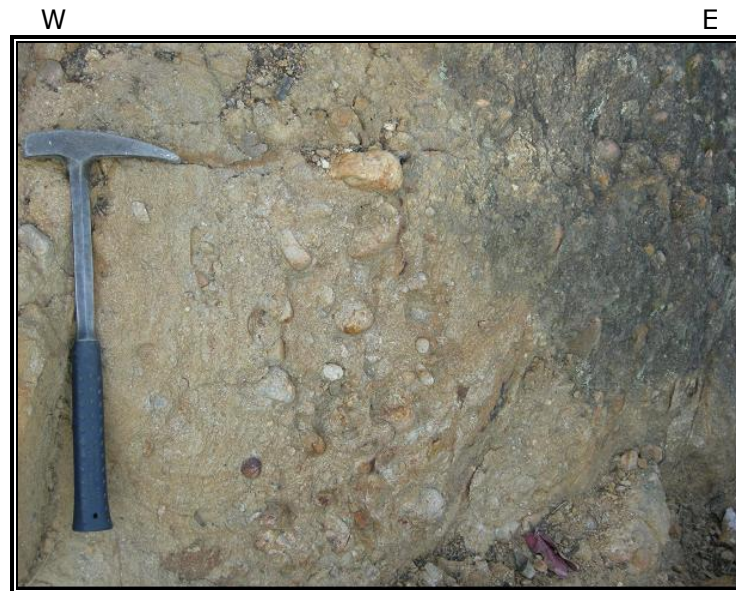
Foto S4. Estación S4: Detalle de conglomerados matrizsoportados, con guijos redondeados de cuarzo y líticos sedimentarios principalmente, en matriz de arenitas sublíticas levemente oxidadas. Formación Los Medios.
