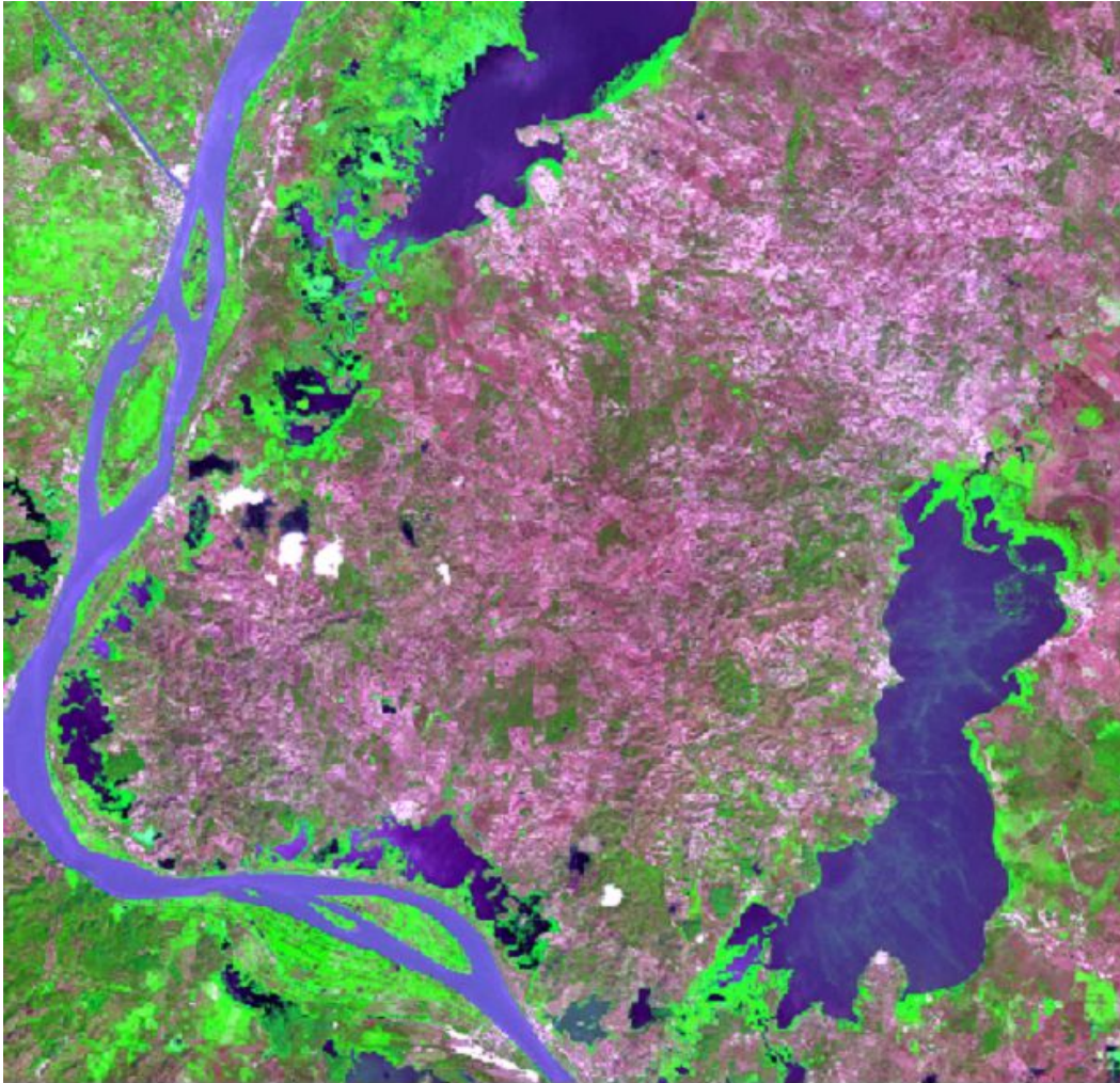
Figura 16. Imagen Spot 5. Bandas 4,3,2 (R,G,B). Región bajo Magdalena. Obsérvese en azul el cauce del río y sectores de ciénagas.
