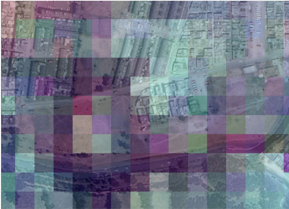
Figura 9 Vista comparativa de la resolución espacial de una imagen Landsat TM (30 m/píxel) y una imagen Quickbird (60 cm/píxel, imagen de fondo). Nótese que en cada píxel de la imagen Landsat que representa un único valor y elemento, se distinguen varios elementos sobre la imagen de alta resolución espacial.
