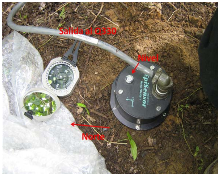
Figura 7. Sensor episensor, se muestra el nivel y la dirección a la cual es orientado.
