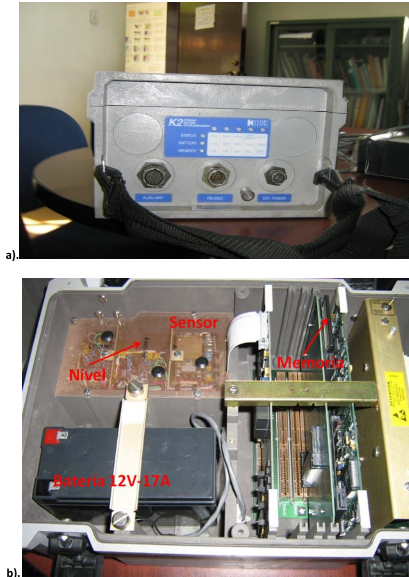
Figura 7. a). Equipo Altus K2, Kinimetrics. b). Interior del equipo K2, sensor del acelerómetro, nivel interno y memoria flash.
