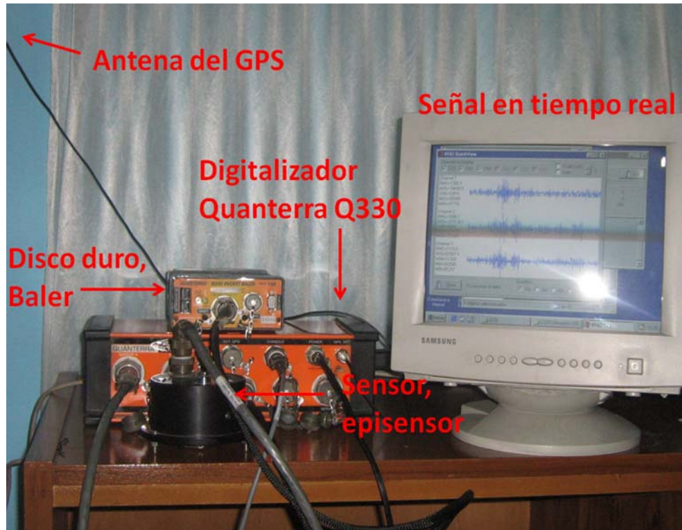
Figura 6. Sistema digitalizador equipo Quanterra Q330, accesorios antena GPS y disco duro externo.
