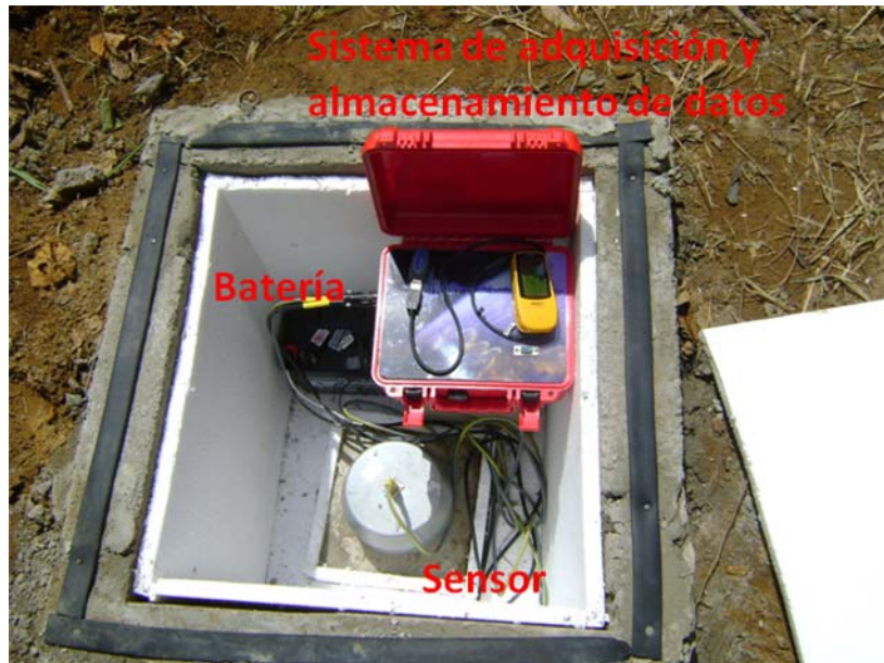
Figura 17. Estación sismológica dentro de la caseta.
