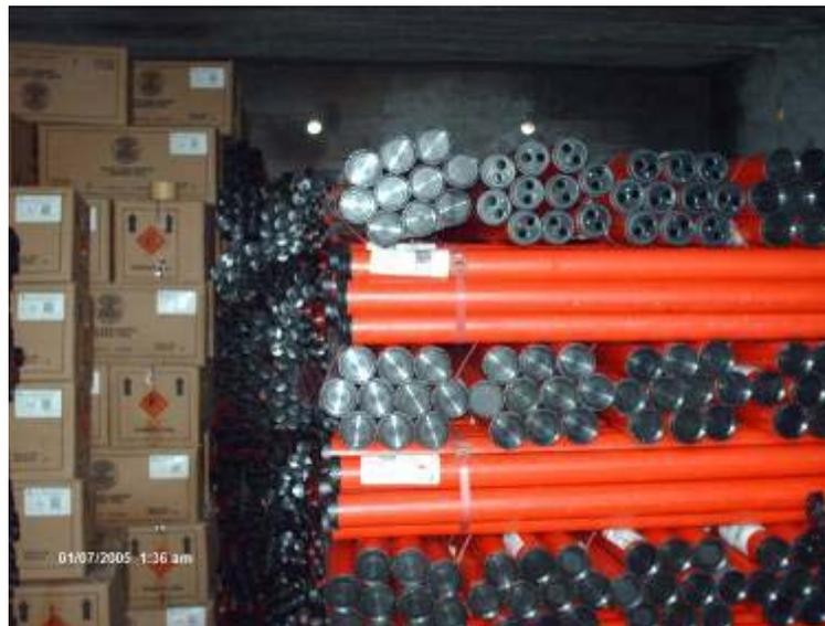
Fotografía 13 Almacenamiento de sismigel
