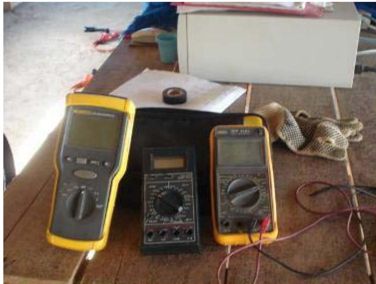
Fotografía 22 Equipos de chequeo de geófonos. Multímetros digitales
