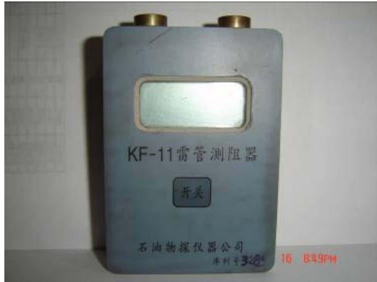
Fotografía 15 Galvanómetro KF-11
