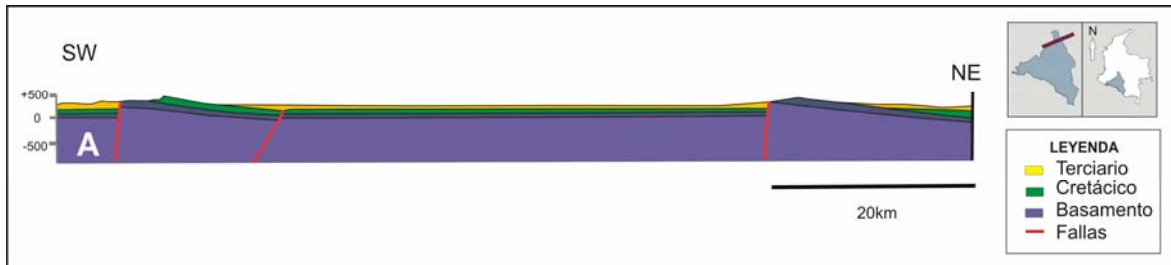
Sección esquemática A. Zonas de prospección con fallas de alto ángulo. Tomado de AMOCO, 1987.
