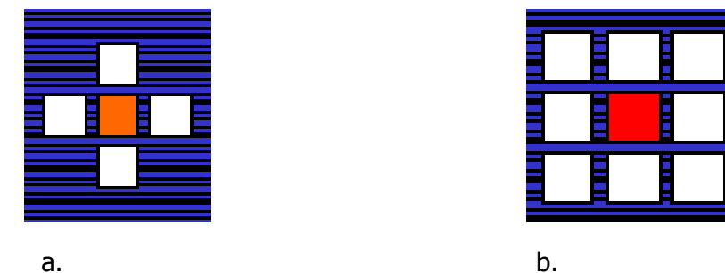
Figura 11. Diagramas de la vecindad: a. Vecindad de Neumann. b. Vecindad de Moore.
