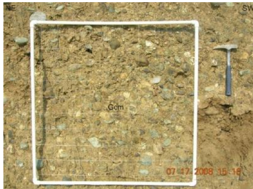
Figura 56. Conglomerado polimítico clastosoportado masivo (Gcm) de la Formación La Paila (Malla 20), Vía Bugalagrande – Galicia, borde de carretera, clastos subredondeados de baja esfericidad, moderadamente seleccionado, predominio de basaltos, matriz compuesta por Arenita media moderadamente seleccionada.
