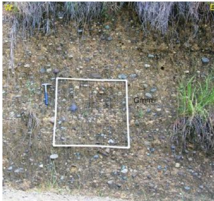
Figura 48. Conglomerado polimíctico matrizsoportado (Gmm) de la Formación La Paila (Malla 17), Vía Bugalagrande – Galicia, borde de carretera, clastos subredondeados de alta esfericidad, moderadamente seleccionado, predominio de basaltos, matriz compuesta por Arenita media moderadamente seleccionada.
