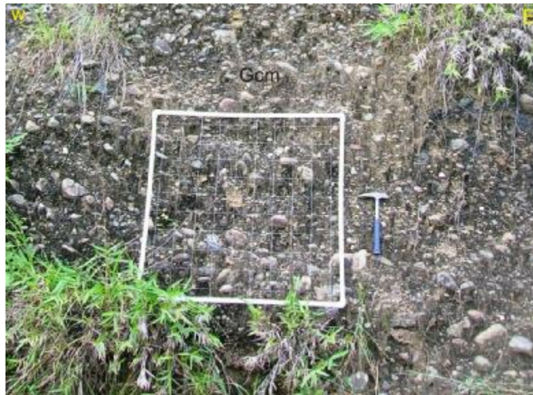
Figura 54. Conglomerado polimítico clastosoportado masivo (Gcm) de la Formación La Paila (Malla 19), Vía Bugalagrande – Galicia, borde de carretera, clastos subredondeados de alta esfericidad, moderadamente seleccionado, predominio de basaltos, matriz compuesta por Arenita media moderadamente seleccionada.
