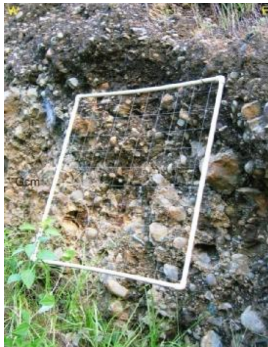
Figura 74. Conglomerado polimítico clastosoportado masivo (Gcm) de la Formación La Paila (Malla28), Vía Buga – La Habana, borde de carretera, clastos subredondeados de alta esfericidad, mal seleccionados, predominio de gabros y basaltos, matriz compuesta por Arenita media a fina moderadamente seleccionada.
