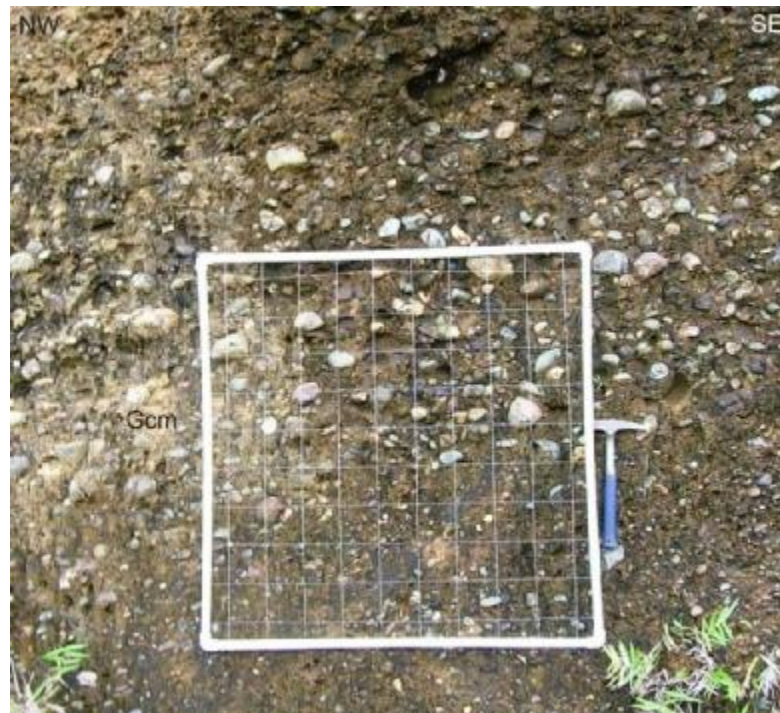
Figura 58. Conglomerado polimíctico clastosoportado masivo (Gcm) de la Formación La Paila (Malla 21) Vía Bugalagrande – Galicia, borde de carretera, algunas zonas matrizsoportadas, clastos subredondeados de alta esfericidad, predominio de basaltos, matriz compuesta por Arenita media a fina moderadamente seleccionada.
