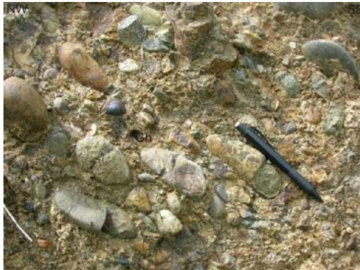
Figura 20. Vía Uribe – Sevilla, en potrero, conglomerado clastosoportado con imbricación (Gh), clastos subredondeados a subangulares de baja esfericidad, predominio de basaltos y gabros, matriz de Arenita gruesa.
