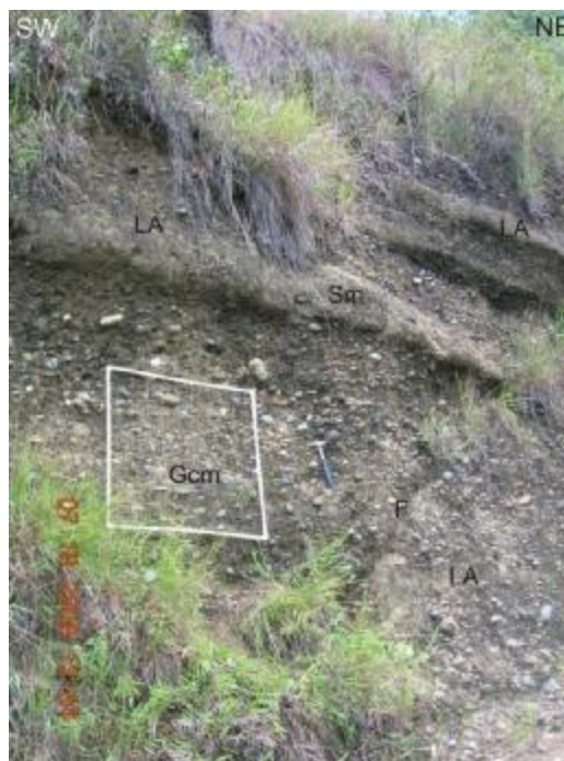
Figura 60. Conglomerado polimíctico clastosoportado masivo (Gcm) de la Formación La Paila (Malla 22), Vía Bugalagrande – Galicia, borde de carretera, clastos subredondeados de alta esfericidad, mal seleccionados, predominio de basaltos, matriz compuesta por Arenita media a fina moderadamente seleccionada.
