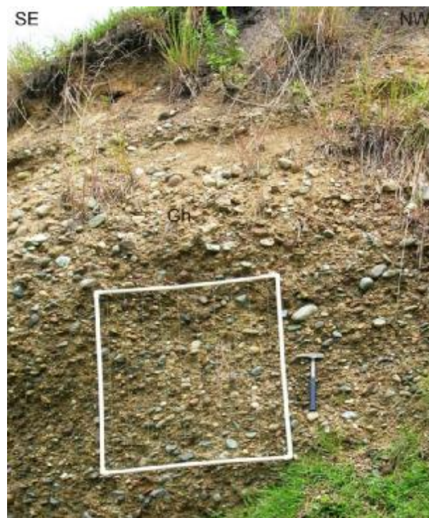
Figura 42. Conglomerado polimítico clastosoportado con imbricación (Gh) de la Formación La Paila (Malla 14), Vía Bugalagrande – Galicia, potrero, clastos subredondeados de baja esfericidad moderadamente seleccionado, predominio de basaltos y chert, matriz compuesta por Arenita media a gruesa mal seleccionada.
