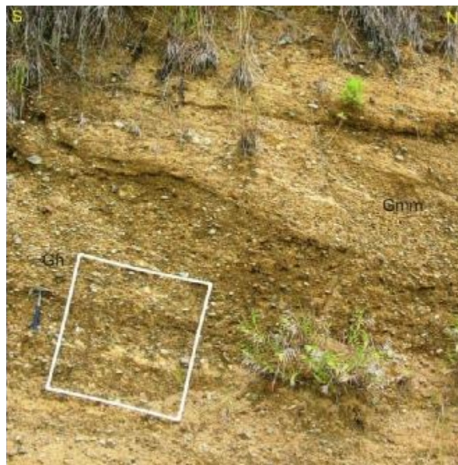
Figura 50. Conglomerado polimítico de la Formación La Paila (Malla 18), Vía Bugalagrande – Galicia, borde de carretera, conglomerado con niveles de gravas clastosoportadas con imbricación (Gh) variando a matrizsoportadas (Gmm), clastos subredondeados de baja esfericidad, mal seleccionado, con predominio de basaltos, matriz compuesta por Arenita media moderadamente seleccionada.
