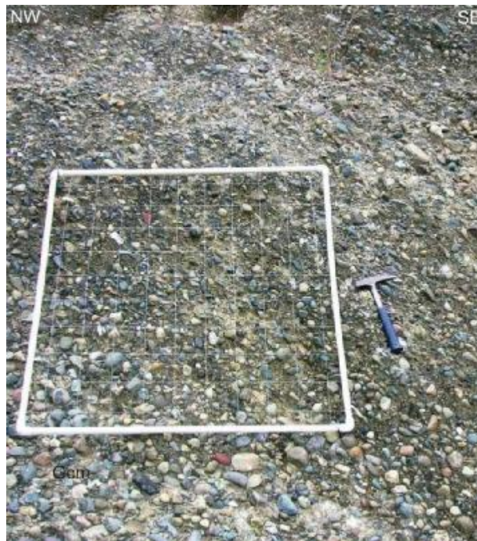
Figura 40. Conglomerado polimítico clastosoportado masivo (Gcm) de la Formación La Paila (Malla 13), Vía Bugalagrande – Galicia, borde de carretera, clastos redondeados de alta esfericidad, predominio de basaltos y chert, matriz compuesta por Arenita gruesa mal seleccionada.
