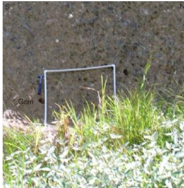
Figura 77. Conglomerado polimítico clastosoportado masivo (Gcm) de la Formación La Paila (Malla 30), Vía Uribe – Sevilla, borde de carretera, clastos subredondeados de baja esfericidad mal seleccionados, predominio de basaltos, matriz de Arenita media a fina compuesta por cuarzo, chert y fragmentos líticos.
