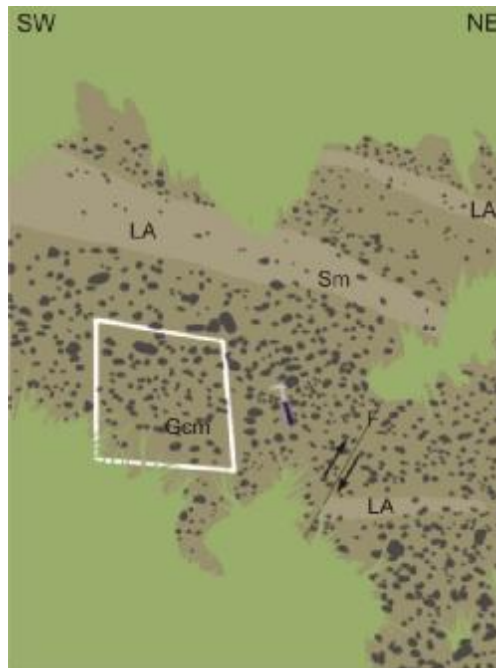
Figura 61. . Conglomerado polimíctico clastosoportado masivo (Gcm), en el cual se presentan algunos paquetes de arena (Sm) en forma de lentes (LA), hacia la parte inferior uno de ellos está siendo afectado por una falla (F) de movimiento inverso con una dirección N5°W/46°SW. Esquema de la figura anterior.
