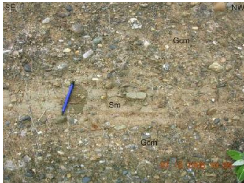
Figura 33. Conglomerado polimíctico clastosoportado masivo (Gcm), Vía Uribe – Sevilla, borde de carretera, predominio de clastos subredondeados de alta esfericidad mal seleccionados, prevalecen los basaltos, la matriz es de Arenita media a gruesa.
