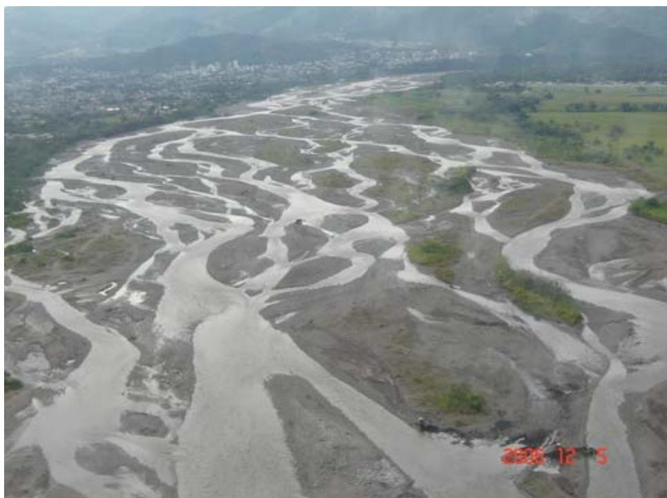
**Figura 22.** Río Guatiquía, Colombia. Ejemplo típico de Río trezado donde se depositan facies como Gh, Gp y Gt.
