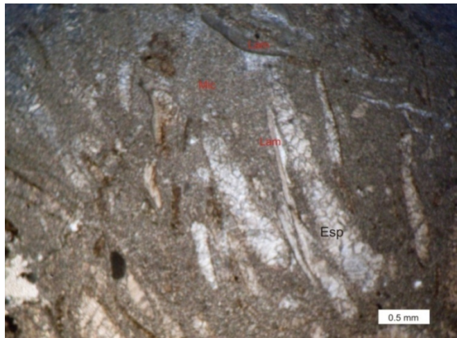
Figura 2. Biomicrita compuesta principalmente por micrita (Mic), esparita (Esp) y bioclastos como lamelibranquios (Lam). NII
