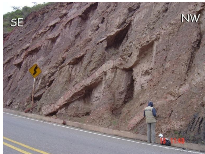
Figura 32. Vía Peaje Sáchica – Alto del Arrayán, margen derecha de la vía en sentido SE, a 300 metros después de la entrada por carretera destapada a las Pinturas Rupestres. Estratos de arenitas calcáreas meteorizadas con leve plegamiento, interestratificadas con lodolitas grises fuertemente meteorizadas.
