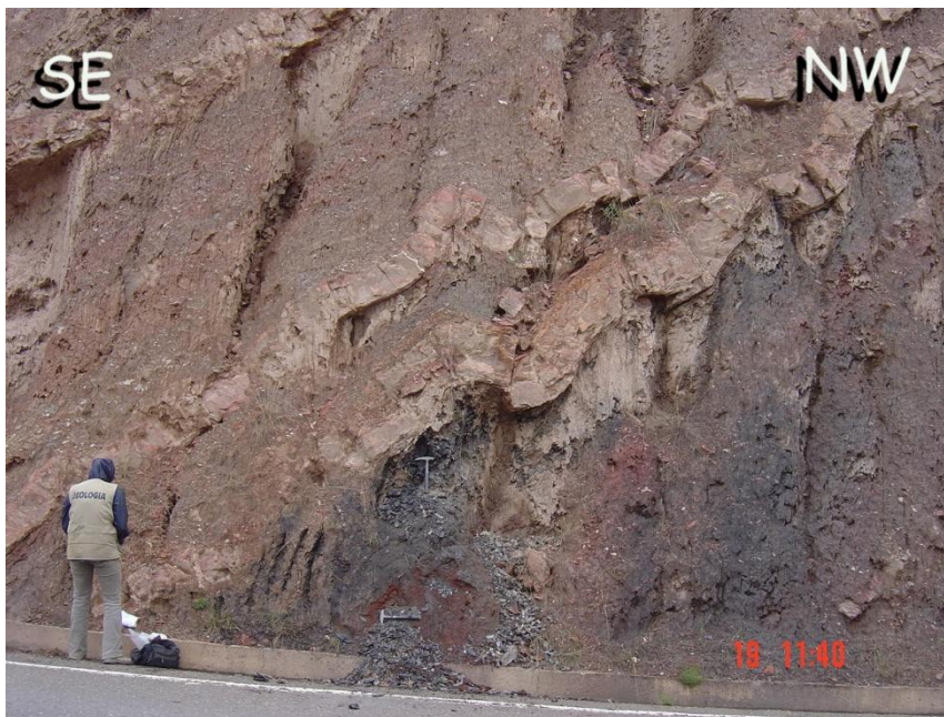
Figura 53. Vía Peaje Sáchica – Alto del Arrayán. Plegamientos en estratos de lodolitas negras y limolitas grises. La coloración del afloramiento se debe al lavado de rocas calcáreas suprayacentes.
