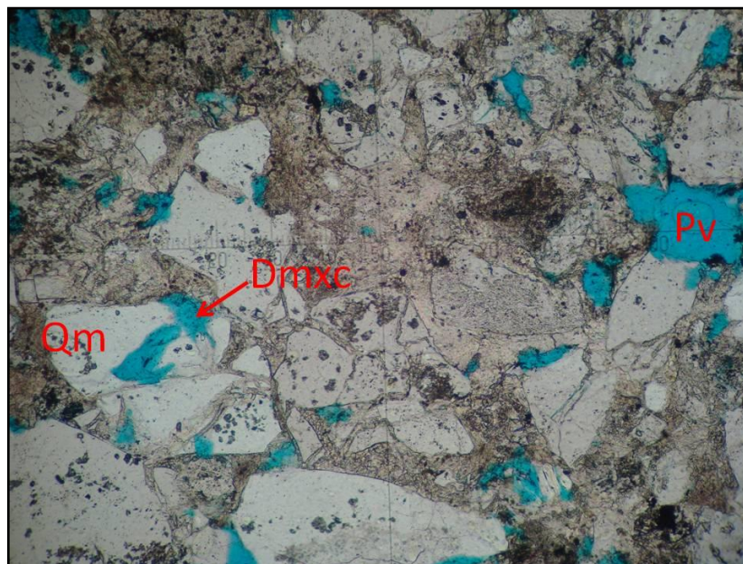
Figura 56. Sublitoarenita Madura se observa porosidad vugular (Pv) por disolución del metasomatismo de cuarzo monocristalino (Qm) por carbonato (Dmxc); muestra P8(2)-80.5-P002 100x-LP.
