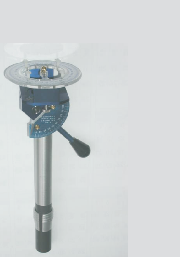
Fig. 9 MODEL OR-2 POMEROY ORIENTING FIXTURE: Se utiliza para medir la dirección y la inclinación de los núcleos perforados en el lugar con una broca de 1 1/8". Cuenta con un tubo de aluminio anodizado y una plataforma de orientación que se ajusta con un trípode de sujeción parecido a una cabrilla. Incluye una cuña cilíndrica pequeña, que puede montarse en el tubo (como se muestra en la parte inferior de la foto) y se usa para bloquear la orientadora en el lugar sobre el núcleo mientras que las mediciones se están realizando. La plataforma es mecánica para dar cabida a una brújula de sol. Ref. 5
