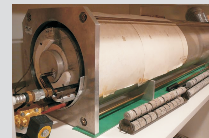
Fig. 7 MODEL TD-48SC THERMAL DEMAGNETIZER: Se utiliza para proporcionar la desmagnetización térmica progresiva de las muestras de roca por el calor a cualquier temperatura especificada hasta 800 ° C y después de enfriamiento en un ambiente de campo magnético de baja (<10 nT). Ref. 5
